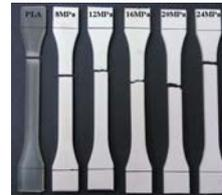
图2-11 PLA发泡样品典型的拉伸断口形貌
